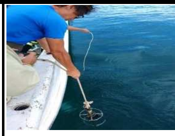
藻場調査時の海洋観測 水温 塩分 溶存酸素などを 計測しています
