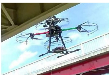
ドローンによる点検
