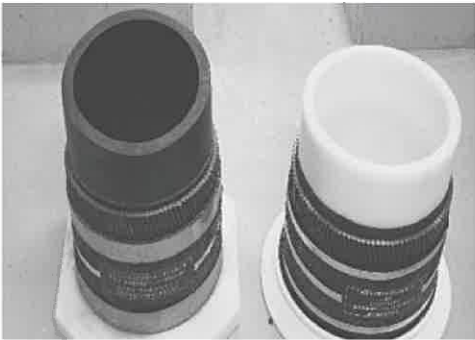
敷設された取水管のサンプル
