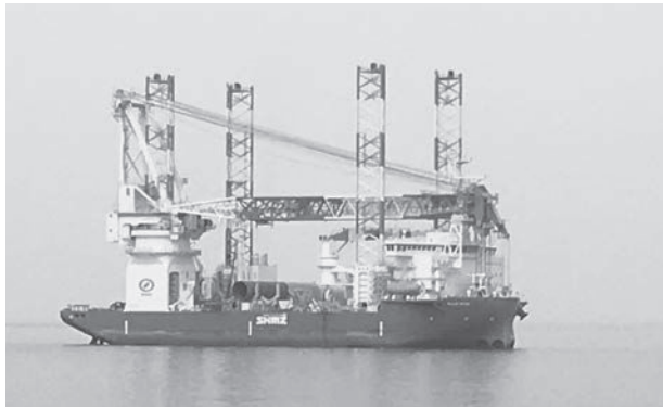
洋上風力発電建設中のSEP船
