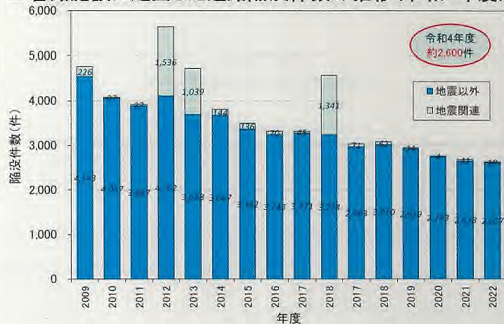
■ 管路施設に起因した道路陥没件数の推移(令和4年度)
