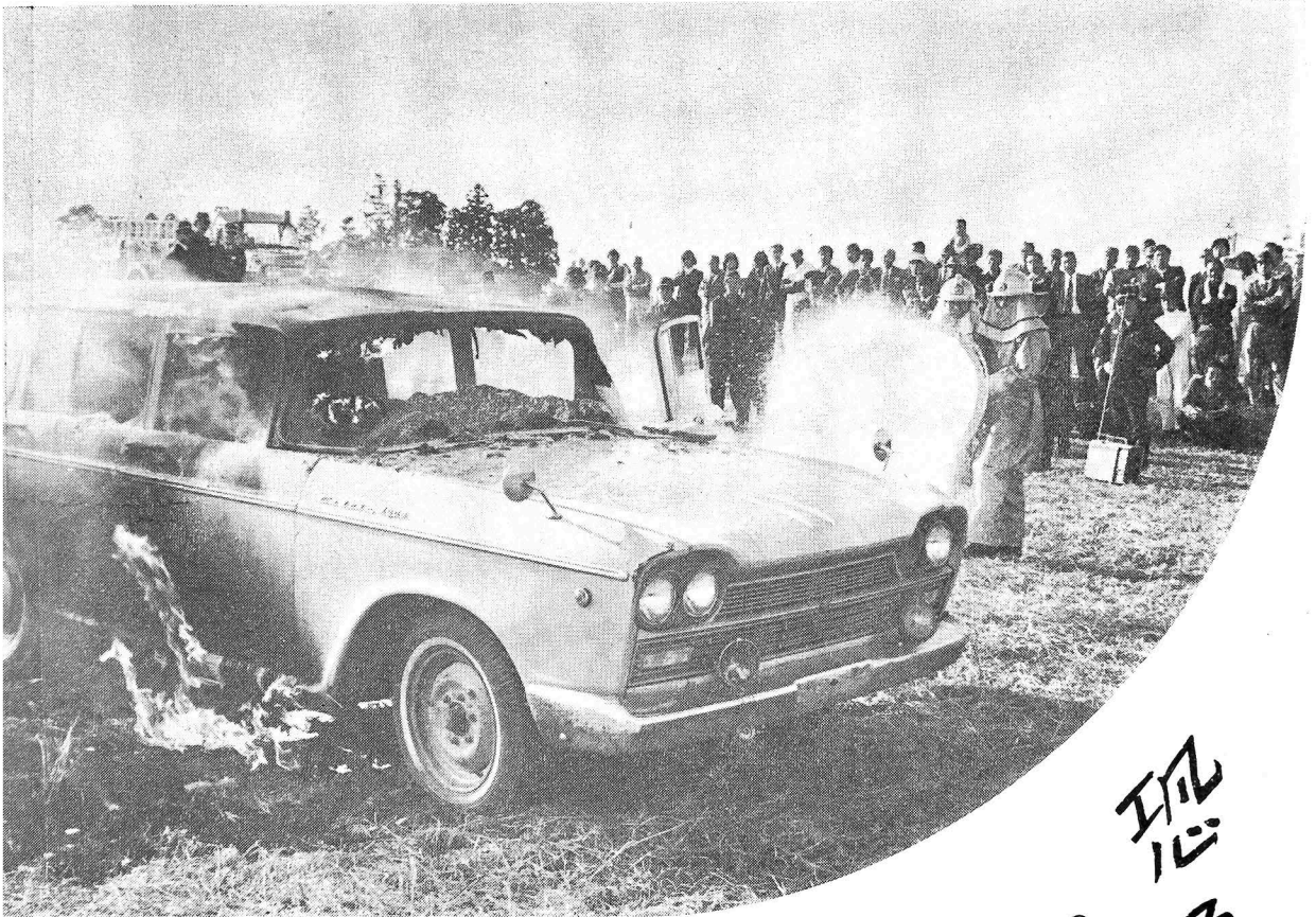
↑写真は車火災の消火実験
