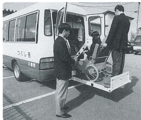
▲後部のリフトを使って車いすのまま乗り降りできるつくし号。操作はボタンで簡単にできます。
