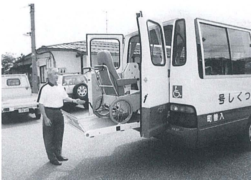
▲つくし号に備え付けてある、車いす専用リフトの操作を行う島倉さん
