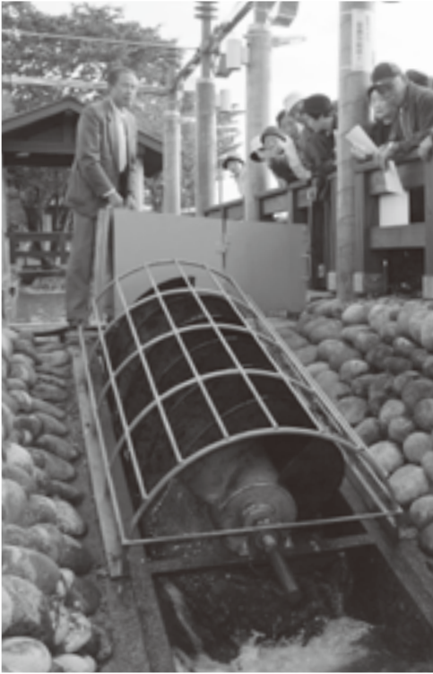
実証実験を重ね、小水力発電の普及、実用化を目指します。IIダイオード（せん水車）を使った「水の小径」の発電実験
